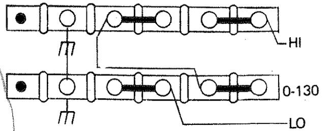
NOTE: FOR TANDEM OPERATION INTERNAL JUMPERS FOR OUTPUT TRANSFORMER MUST BE CHANGED REFER TO 501A SCHEMATIC
